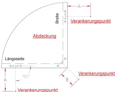
Die Gummispanner (an der Verschlussseite des Kunststoffhakens nach oben zeigend) in Höhe der Treppenabdeckung sowie auf der Hauptabdeckung (gegenüber der Treppe) befestigen, um eine gleichmäßige Straffung zu gewährleisten und zu verhindern, dass sich die Hauptabdeckung zur Treppe hin verschiebt.
