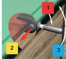
Das Endstück der Kurbel bzw. des Kurbelrads (Außenvierkant) mit der Wickelachse verbinden (Innenvierkant).
