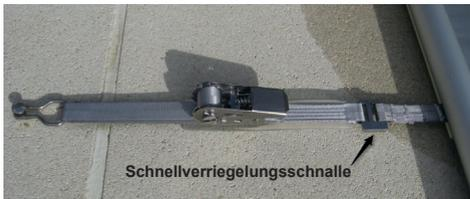
Jede Spannratsche mehrmals betätigen, um eine optimale, einheitliche Spannung an der Abdeckung zu erzielen. **Die Abdeckung gleichmäßig straffen, indem die Ratschen symmetrisch bedient werden**, da sonst die Abdeckung beschädigt werden könnte. Die Installation durch Umlegen der Spannratschen in die Waagrechte beenden.
